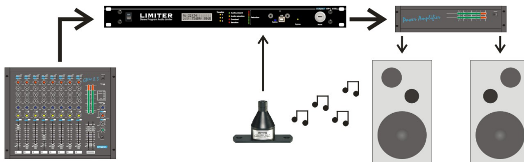
Image 1 : raccordement du SPL-5 MK2
