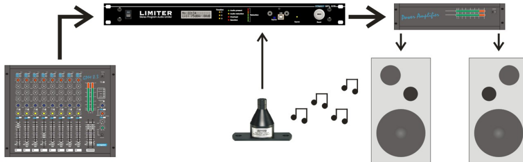
Abbildung1: Anschließen des SPL-5 MK2
