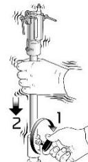
**WARNUNG!** Der teleskopische Teil darf die maximale Höhe nicht erreichen. Sobald die Beschriftung "STOP" oder "MAX" auf dem Teleskoprohr sichtbar ist, senken Sie den teleskopischen Teil sofort ab.
