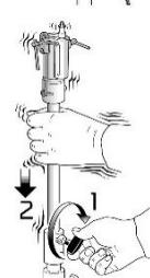
**ADVERTENCIA!** Es posible que la sección telescópica no alcance la altura máxima. Tan pronto como la etiqueta "STOP" o "MAX" sea visible en el tubo telescópico, baje la parte telescópica inmediatamente.
