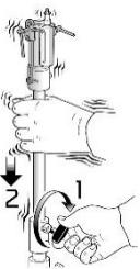
ATTENTION! La section télescopique ne doit pas atteindre la hauteur maximale. Dès que l'étiquette "STOP" ou "MAX" est visible sur le tube télescopique, abaissez immédiatement la partie télescopique.
